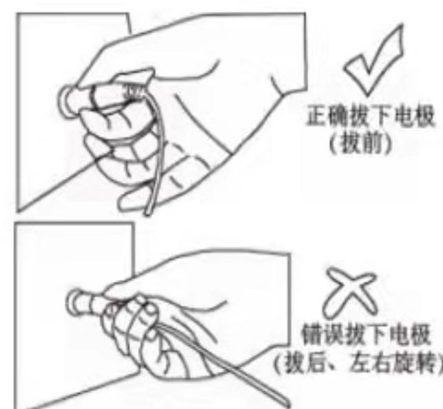
图 3 拔下电极线
